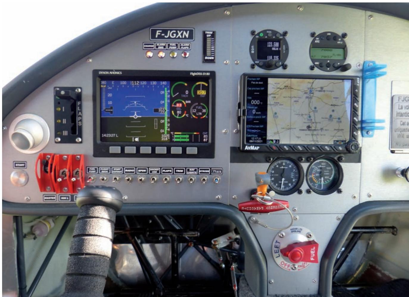
La machine essayée est équipée d'un EFIS/EMS Dynon et d'un GPS AvMap. Au-dessus de ce dernier, on trouve la radio et le transpondeur et, en dessous, un badin et un altimètre analogiques de secours. À gauche, la commande des volets électriques, les contacts et le bouton du démarreur.
